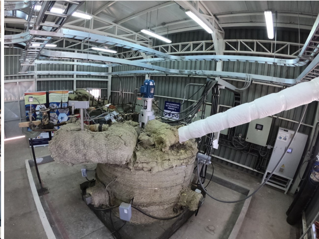
LOOP DE SALES FUNDIDAS + TANQUE 1 TON + SISTEMA PRUEBAS CORROSIÓN
