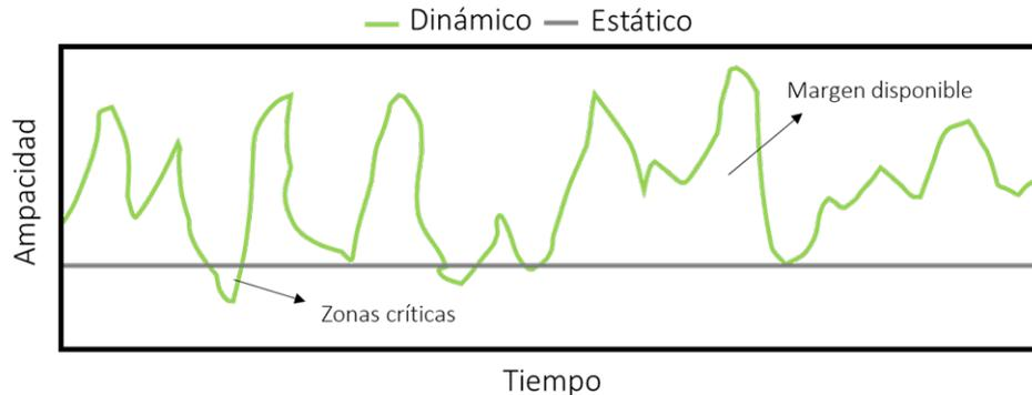
Las herramientas de visualización permitirán observar y comparar en tiempo real el valor estático de capacidad con el cual se opera el activo y el valor estimado en función de las condiciones ambientales reales.
